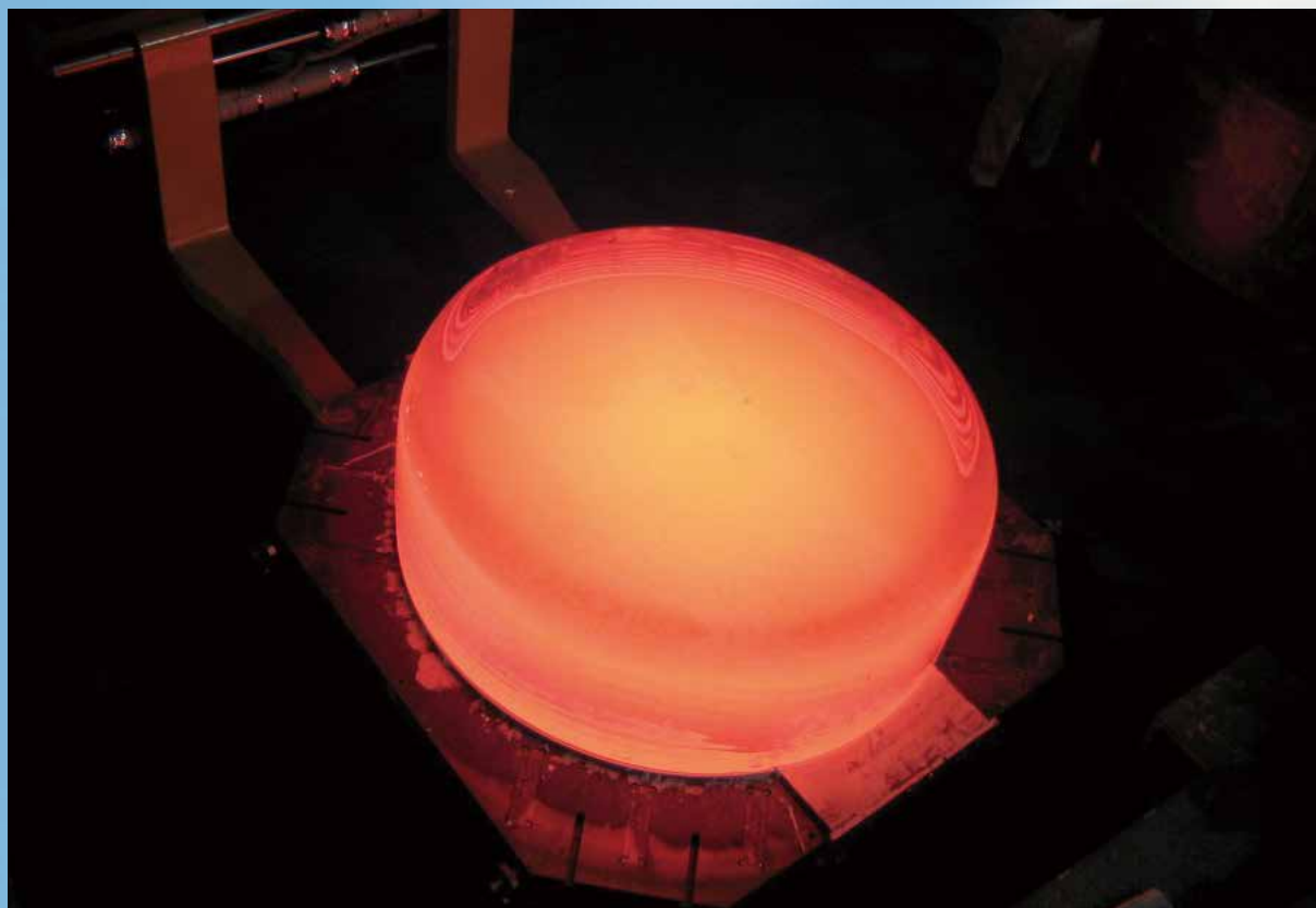
φ1.5m超 CLEARCERAM™-Z ガラスブランク成形品 CLEARCERAM™-Z Glass Blank (Diameter: Over 1.5m)
